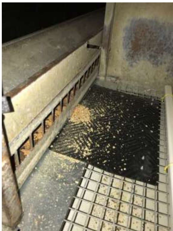
Bild 4. Ströytan är monterad och strö har tillförts. Unghönsbur hos Närkesberg.
